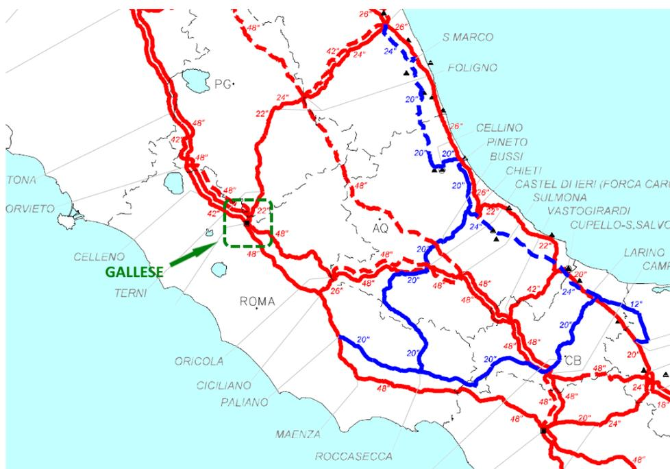
Figura 14 - Stralcio della cartina della Rete Nazionale dei Gasdotti con localizzazione della Centrale di Compressione Snam di Gallese
